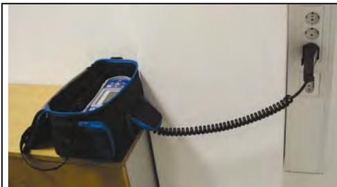
Das Instrument kann sogar in der gepolsterten Tragetasche benutzt werden - das Prüfkabel wird durch die Öffnung vorn angeschlossen.
