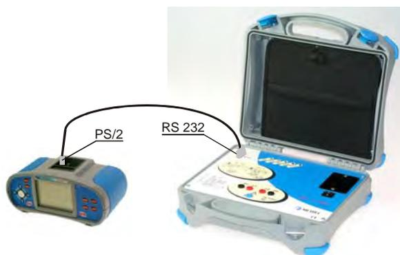
Abb. 5.49: Anschluss des Impedanzadapters an das Instrument
