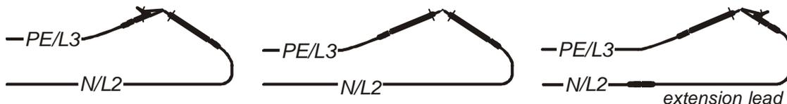
Abb. 5.11: Kurzgeschlossene Prüfspitzen – Beispiel Durchgang NPE
